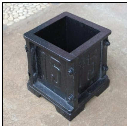
Gambar 1. 2 Bekisting benda uji kubus 15 x 15 x 15
