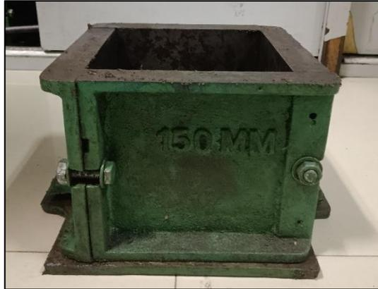
**Gambar 1. 3** Cetakan Kubus yang digunakan
