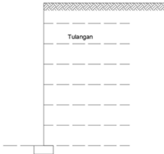
Gambar 2. 11. Dinding Tanah Bertulang
