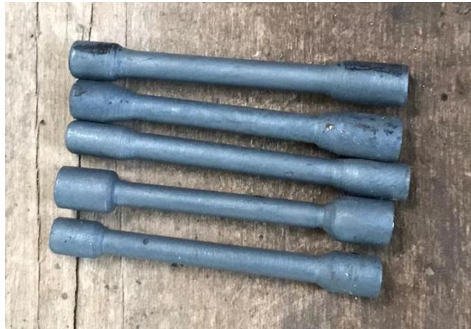
**Gambar 1.1** Spesimen uji setelah di-*heat treatment*
