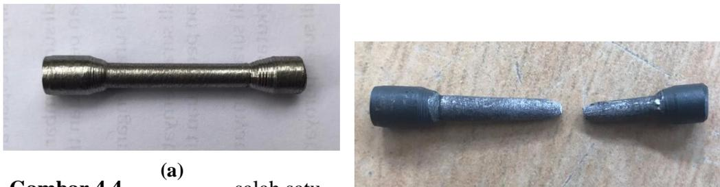
**Gambar 4.4** (a) salah satu spesimen pengujian tarik setelah di-*heat treatment*
