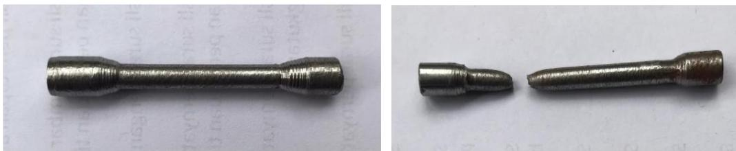
**Gambar 4. 1** (a) Salah satu spesimen pengujian tarik sebelum di- (b) *heat treatment*
