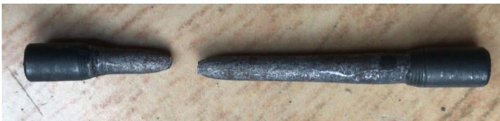
**Gambar 2.5** Hasil spesimen 3 pengujian tarik setelah *heat treatment*.
