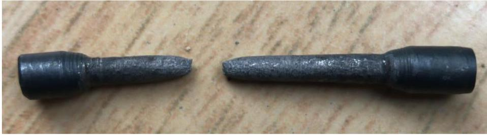
**Gambar 2.1** Hasil spesimen 1 pengujian tarik setelah *heat treatment*.
