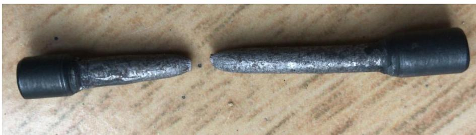
**Gambar 2.3** Hasil spesimen 2 pengujian tarik setelah *heat treatment*.
