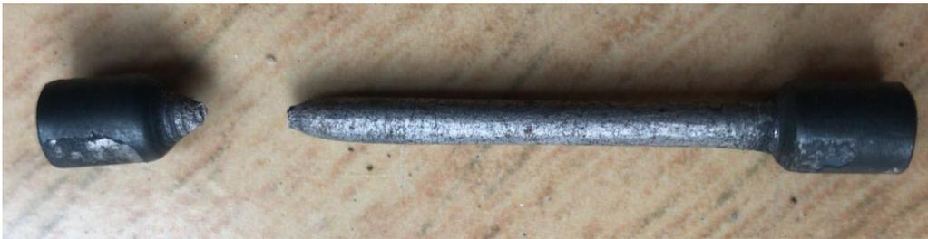
**Gambar 2.7** Hasil spesimen 4 pengujian tarik setelah *heat treatment*.
