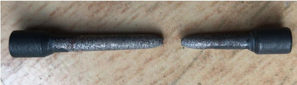
**Gambar 2.9** Hasil spesimen 5 pengujian tarik setelah *heat treatment*.
