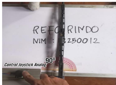
Gambar 4. 5 Pergerakan servo sudut 0^{\circ} - 90^{\circ} diukur secara manual
