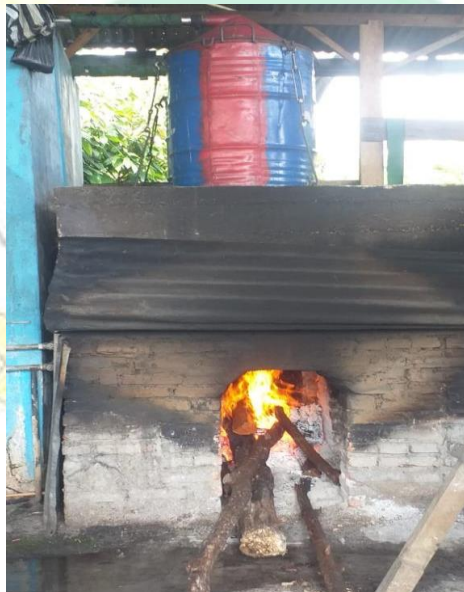
Gambar 3. Proses pemanasan air dan uap air dialirkan ke katel bahan baku.
