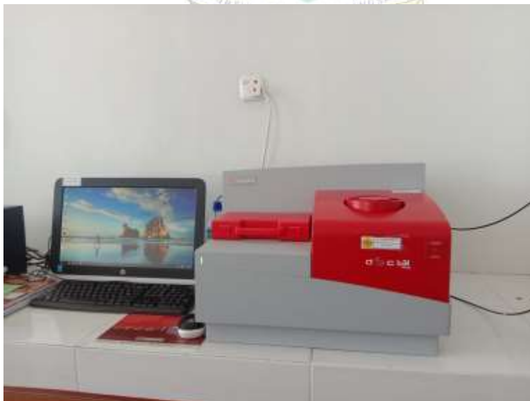
Gambar 31. Alat Uji DSC (Setaram 131-Evo)
