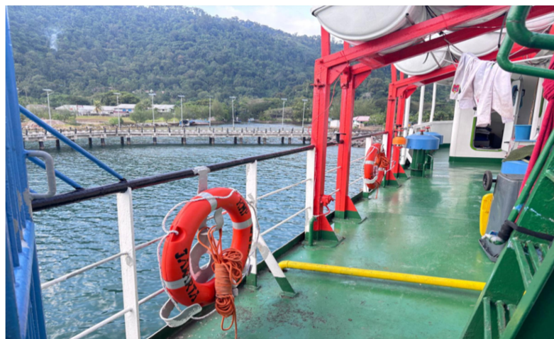
Gambar 4. 7 Kondisi Pelampung penolong ( Lifebuoy ) KMP. Gambolo di Lapangan (Sumber: Dokumentasi 2026)
