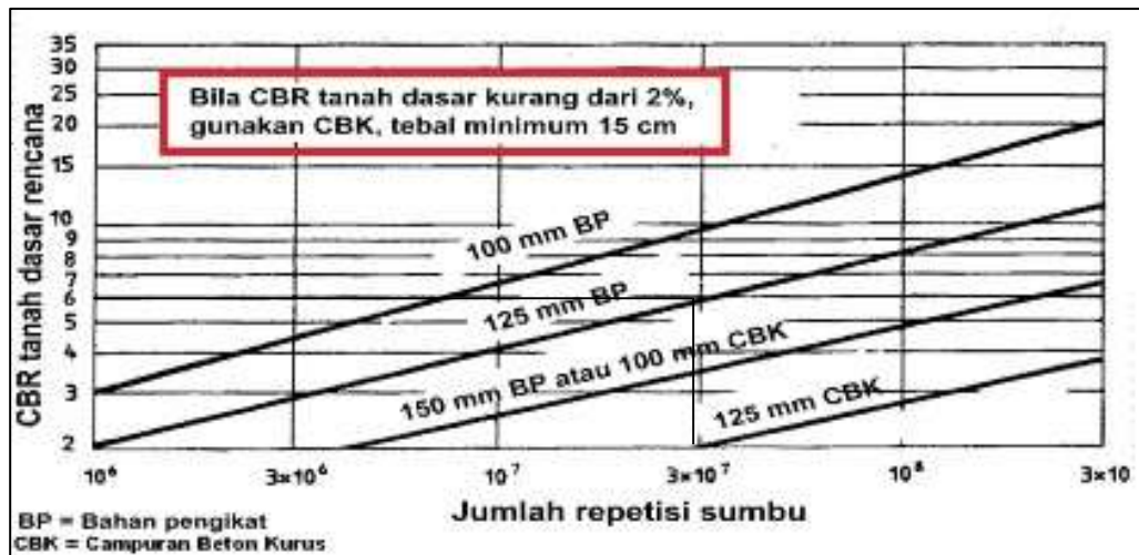
Gambar 2.8. Pondasi bawah minimum untuk perkerasan beton semen
