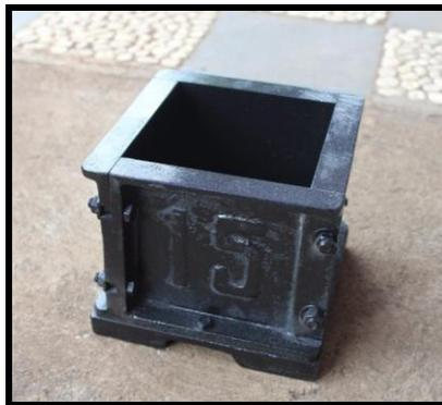
**Gambar 1.2** Model cetakan benda uji kubus
